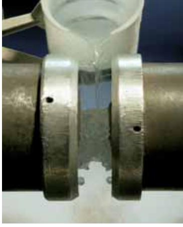
الشكل (٤٤-٥): انجذاب الأكسجين السائل إلى مغناطيس.
