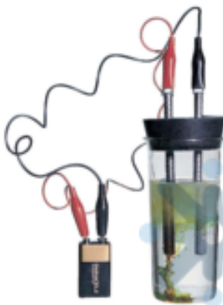
شكل (٢-١٣): خلية تحليل محلول يوديد البوتاسيوم.
